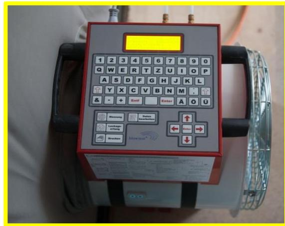
Strumentazione „Blower-Door Test“
